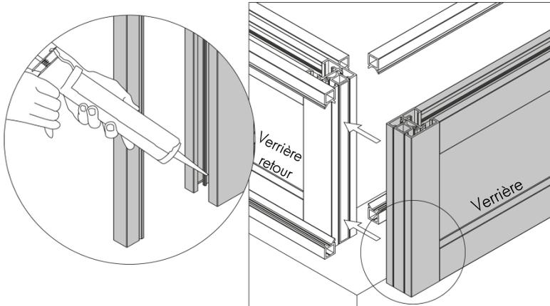
4- Placer / enclencher les éléments suivants
