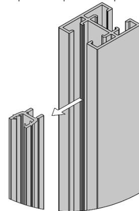
5- Clipper le joint dans le montant de l'élément suivant
