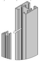
5- Clipper le joint dans le montant de l'élément suivant
